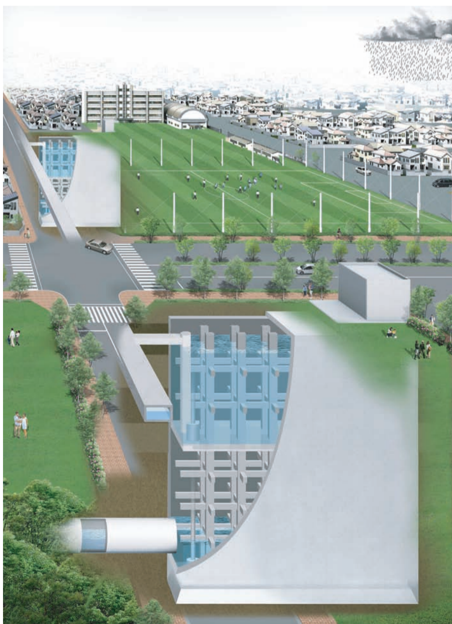
ニューマチックケーソン工法による雨水地下貯留施設
