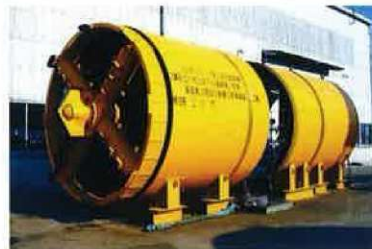
φ3,270mm 泥土加圧掘進機
