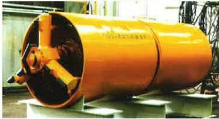
φ1,080mm 泥土加圧掘進機
