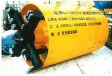
φ1,820mm 泥土加圧掘進機
