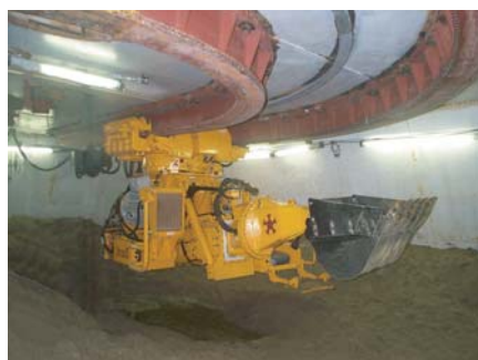
遠隔操作掘削機 (DREAMⅢ型)
