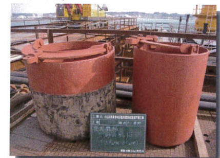
掘削土を入れて地上に出すための容器です。
