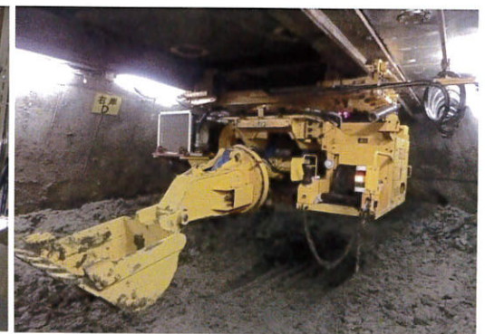
天井走行式函内掘削機で遠隔による掘削をすることができます。
