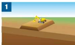
1 センター設置・刃口金物据付
