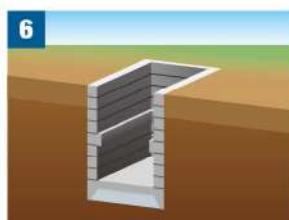
6 機装撤去・完成
