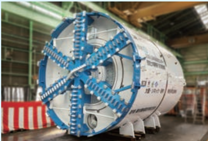
地下貯留管となるトンネル(延長1.7km,内径4.9m)の掘削を行う、シールドマシン
